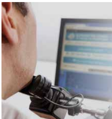
Accediendo al teléfono con el Bjoy ring, que convierte el joystick de la silla de ruedas en un ratón
